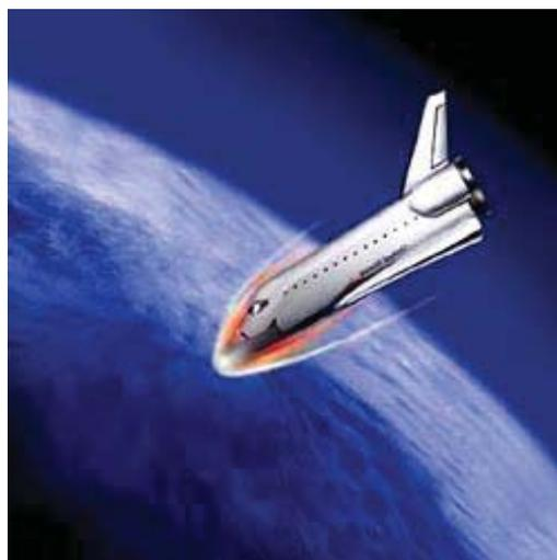
As naves espaciais são dotadas de estrutura adequada de materiais especiais para evitar a sua destruição no reingresso na atmosfera. O atrito causa um calor excessivo, que poderia ser fatal para os astronautas.
