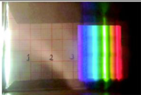
Figura 16 - Espectro observado em um espectroscópio manual com D=12,5cm.
