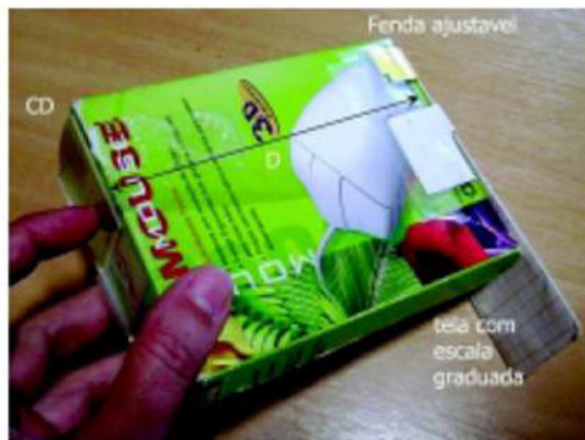
Figura 15 – Espectroscópio manual segundo Cavalcante e Tavoraro [Cavalcante].
