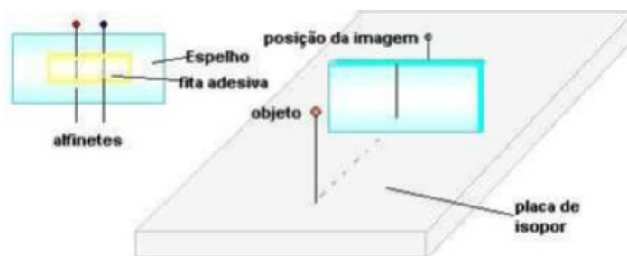
Figura 30 - Montagem para a determinação da posição da imagem. Disponível em: http://portaldoprofessor.mec.gov.br/storage/recursos/14555/formacaoeposicaoadimagemnosespelhosplanos.pdf .
