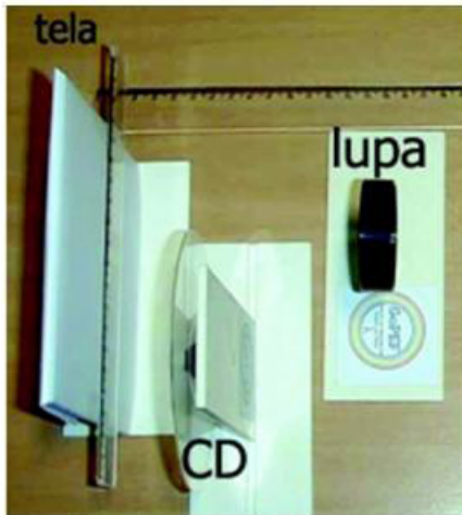
Figura 11 – O CD disposto entre a lupa e a tela para a decomposição espectral.
