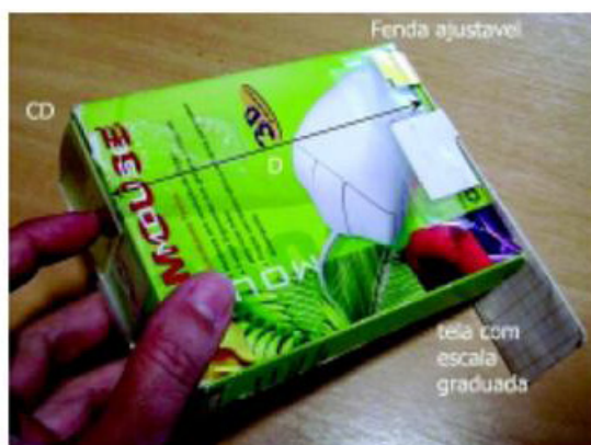
Figura 15 – Espectroscópio manual segundo Cavalcante e Tavoraro [Cavalcante].
