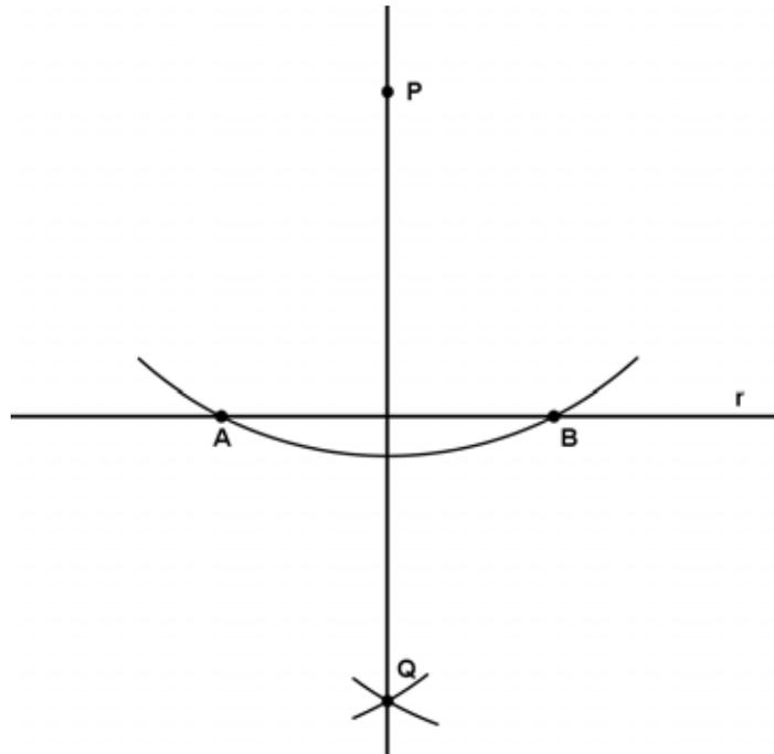
Figura 10.1: Reta perpendicular a  $r$  passando por  $P$ .
