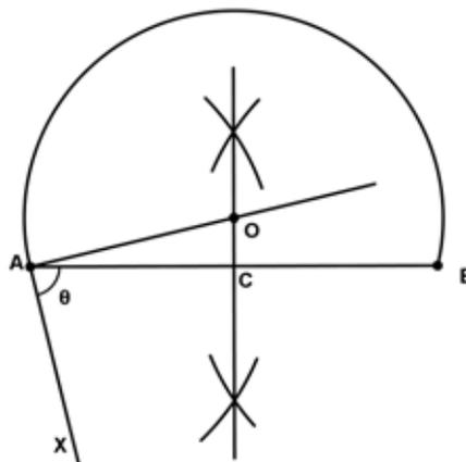
Figura 10.8: Construção do arco capaz.
