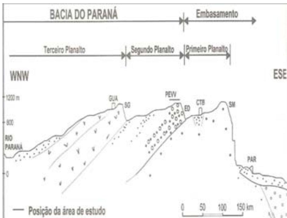
Figura 1.9 – Seção esquemática mostrando a estrutura do relevo do Estado do Paraná. (Fonte: Melo et al., 2005).
