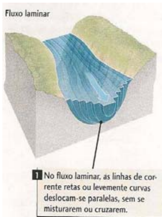
Figura 2.2 – Fluxo laminar. (Fonte: Press, et al., 2006).
