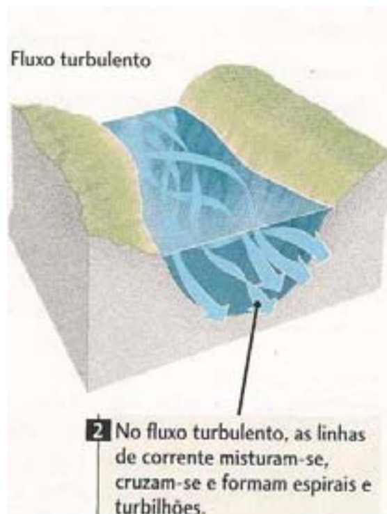
Figura 2.3 – Fluxo turbulento. (Fonte: Press et al., 2006).
