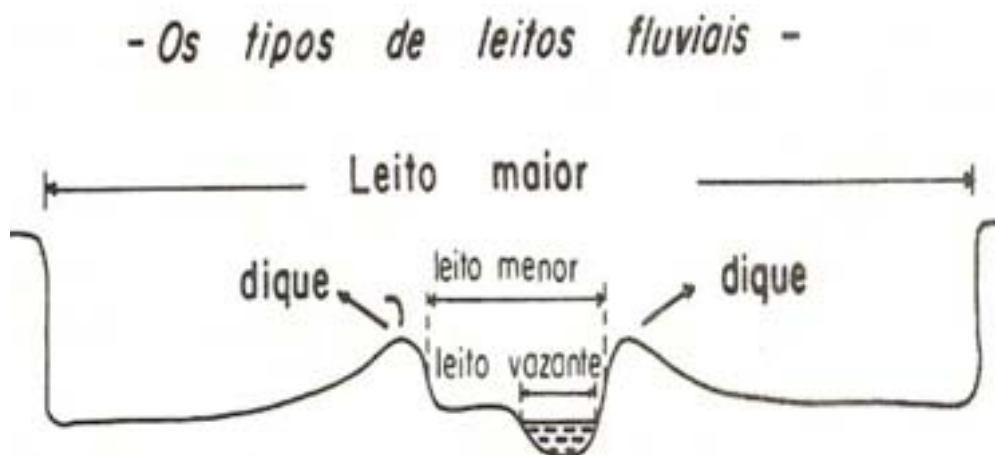
Figura 5.1 – Os tipos de leitos fluviais, notando-se a distinção entre o leito de vazante, o menor e o maior. (Fonte: Christofolletti, 1980).
