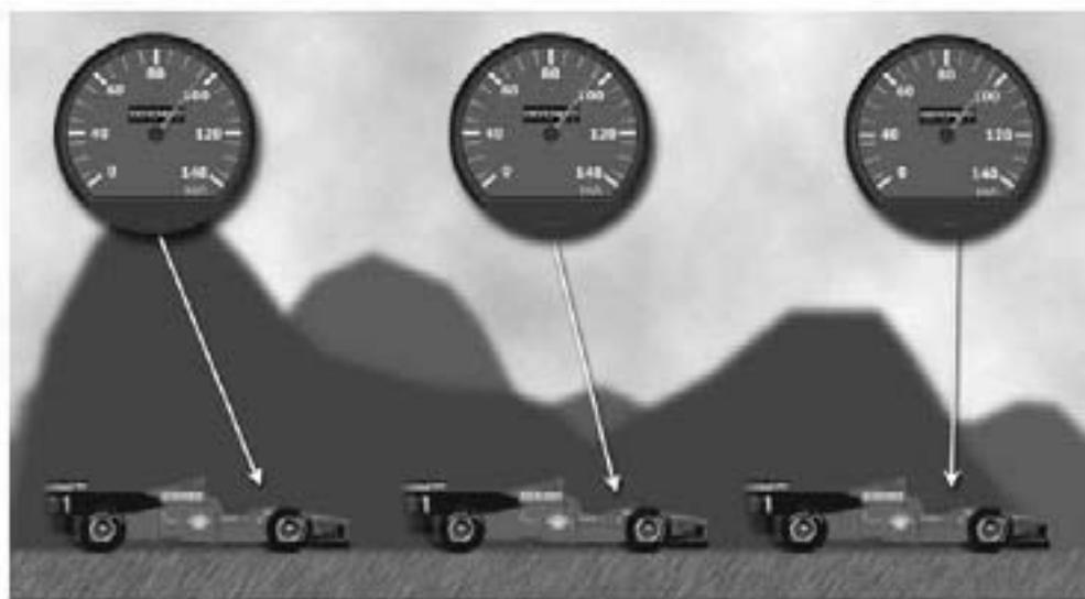
No movimento uniforme a velocidade não se altera, a aceleração é nula ( $a = 0$ ). Sua velocidade é constante, ou seja, não se altera no decorrer do tempo e o móvel percorre espaços iguais em intervalos de tempos iguais.
