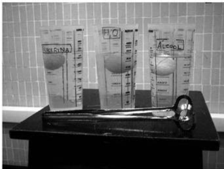
Figura17 – Kit experimental com os corpos imersos nos diferentes fluidos. (Fonte: :[Almeida, Costa, Costa e Bruno]).
