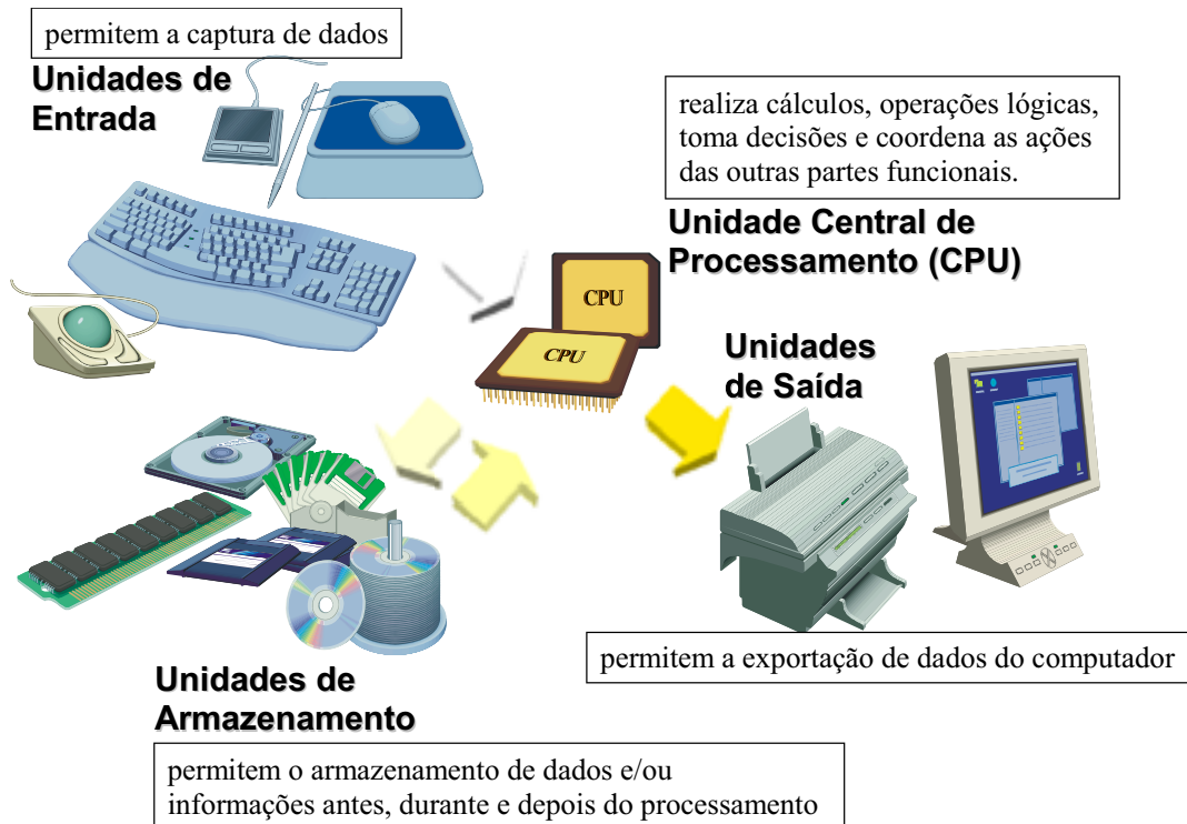
Figura 1.3 – Elementos de hardware de um Sistema Computacional.
