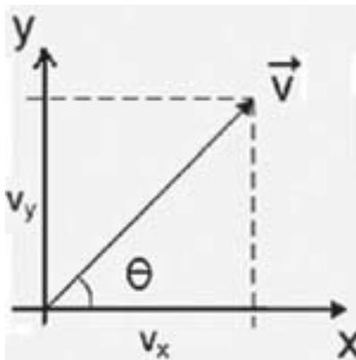
parar as componentes do vetor velocidade  $\vec{v}$  ( $\vec{v}_x$  e  $\vec{v}_y$ ). A componente x do vetor  $\vec{v}$  (designada por  $v_x$ ) é dada pela projeção do vetor no eixo x. Analogamente, a componente y é a projeção do vetor  $\vec{v}$  ao longo do eixo y.
