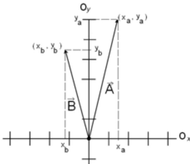
Vetores no plano  $xy$ . As coordenadas  $(x_a, y_a)$  do ponto correspondente a extremidade do vetor  $\vec{A}$  e  $(x_b, y_b)$  do vetor  $\vec{B}$  são marcadas nos eixos  $O_x$  e  $O_y$ .
