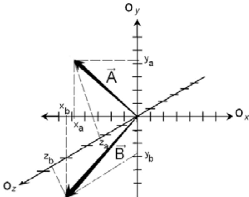
Vetores no espaço tri-dimensional  $xy_z$ . As coordenadas  $(x_a, y_a, z_a)$  do ponto correspondente a extremidade do vetor  $\vec{A}$  e  $(x_b, y_b, z_b)$  do vetor  $\vec{B}$  são marcadas nos eixos  $O_x$ ,  $O_y$  e  $O_z$ .
