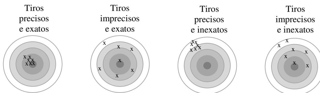
**Figura 1.1. Esquema ilustrativo sobre precisão e exatidão em medições.**
