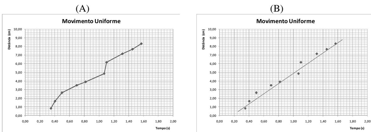
**Figura 1.7: Exemplos de ajustes inadequados: (A) Pontos ligados, sem obedecer a um comportamento funcional; (B) Ajuste linear com tendência evidente para os pontos inferiores.**
