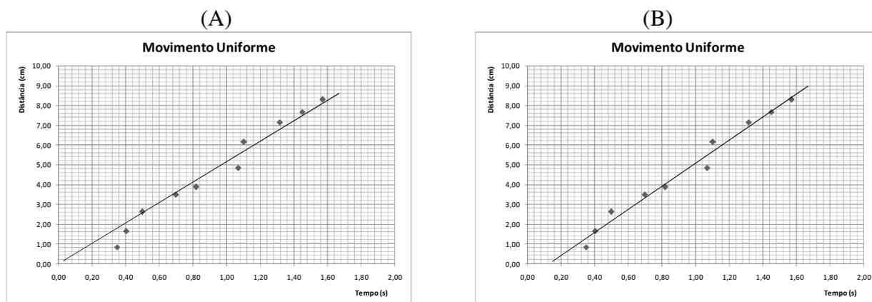
**Figura 1.6: Exemplos de bons ajustes: (A) Ajuste linear passando pela origem,  $y=m.x$ ; (B) Ajuste linear sem restrição para o coeficiente linear,  $y=m.x+n$ .**
