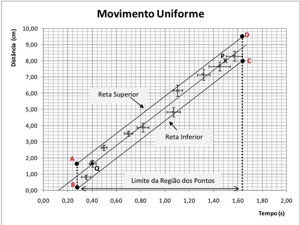
Figura 1.10: Quadrilátero traçado para determinar as incertezas de  $m$  e  $n$ .
