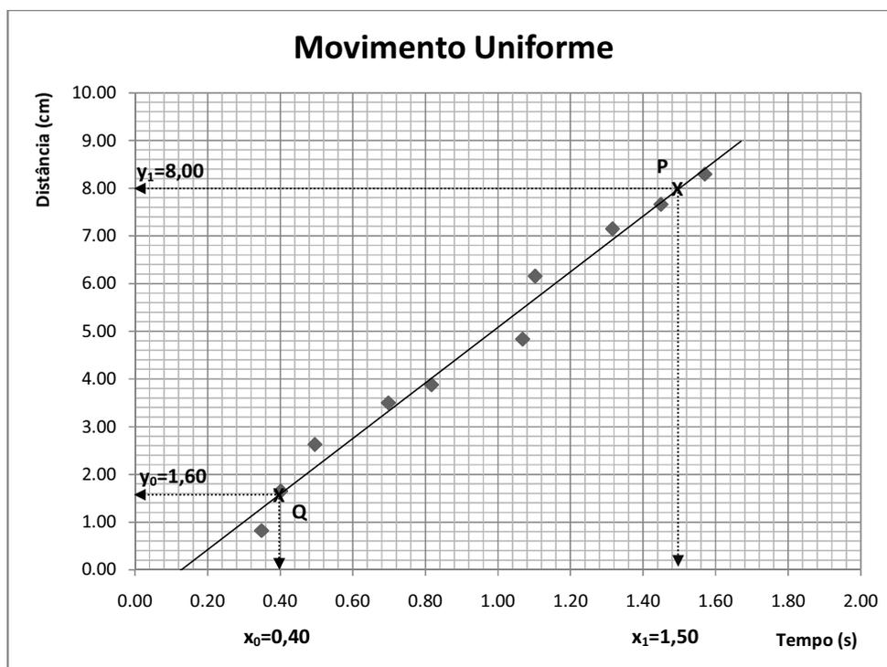
Figura 1.8: Escolha dos pontos para determinação da equação da reta.
