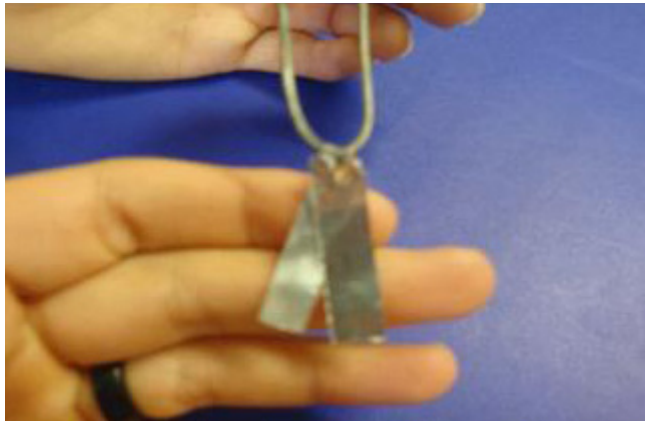
Duas tiras de papel alumínio com 3cm de comprimento cada, presas com 1cm de fio de cobre (número 28), colocadas no gancho.
