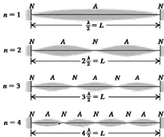
Figura 3.1: De cima para baixo são mostrados as frequências de ressonâncias fundamental ( $n = 1$ ), o segundo ( $n = 2$ ), terceiro ( $n = 3$ ) e quarto ( $n = 4$ ) harmônicos de uma corda de comprimento  $L$ .  $N$  significam nós,  $A$  significam ventres ou anti-nós,
