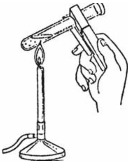
Figura 2. Aquecimento em tubo de ensaio
