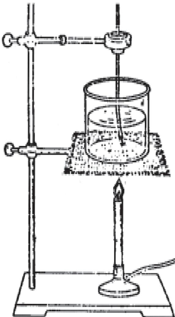
Figura 3. Sistema para aquecimento
