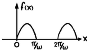
Figura 8.9: A ação do retificador de meia onda sobre uma voltagem senoidal.
