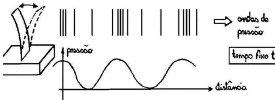
Figura 8.3: Esquema de ondas de pressão no ar (sons) produzidos por um diapasão.
