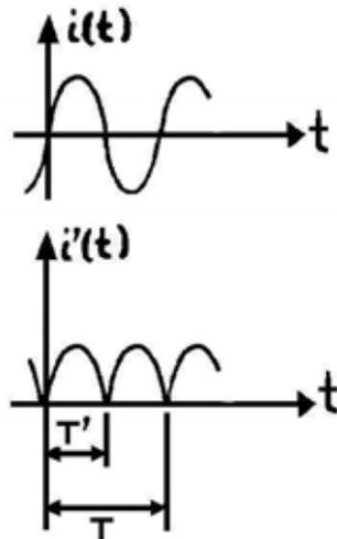
Figura 8.7: A ação do retificador de onda completa.
