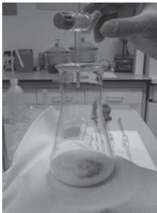
Estudante realizando a titulação de padronização do Nitrato de Prata, uma das etapas do processo de determinação de cloretos num sal de cozinha pelo Método de Mohr (Fonte: http://tal57.blogspot.com ).
