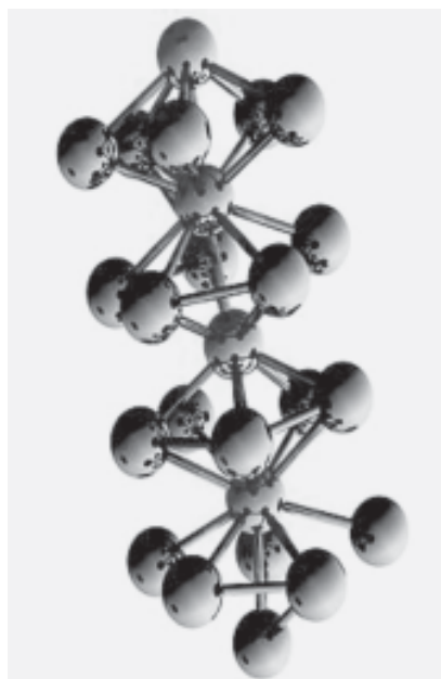
Figura 11: Menor liga metálica composta de um fio de ouro e prata com o comprimento de apenas três átomos, descoberto por pesquisadores da Unicamp e do LCLS (Laboratório Nacional de Luz Síncrotron) (Fonte: www.unicamp.br ).
