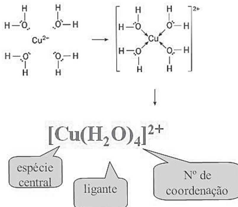
Esquema mostrando a notação do complexo  $[\text{Cu}(\text{H}_2\text{O})_4]^{2+}$ .
