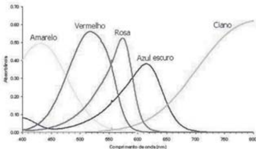
Figura 2. Espectros de absorção de soluções coloridas, onde a cor da linha corresponde a cor da solução.
