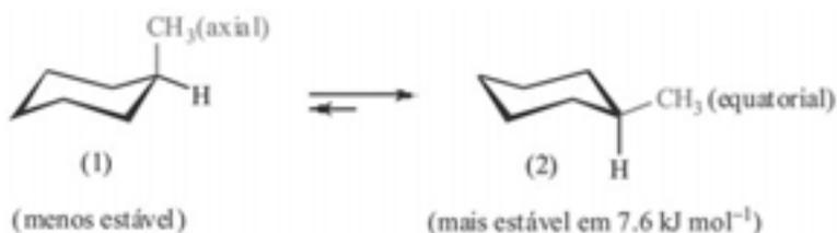
Estudos indicam que a conformação com o grupo metila equatorial é mais estável do que a conformação com o grupo metila axial por aproximadamente  $7,6 \text{ kJ mol}^{-1}$ . Assim, na mistura em equilíbrio, a conformação com o grupo metila na posição equatorial é predominante. Cálculos mostram que ela constitui aproximadamente 95% da mistura em equilíbrio.
