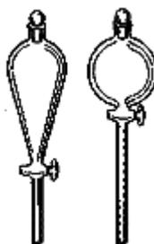
Garra de condensador: usada para prender o condensador a haste do suporte ou outras peças como balões, erlenmeyer, etc.
