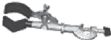
Mufa: suporte para a garra de condensador.
