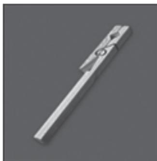
Pinças de Mohr e de Hoffman: usada para impedir ou reduzir a passagem de gases ou líquidos através de tubos flexíveis.
