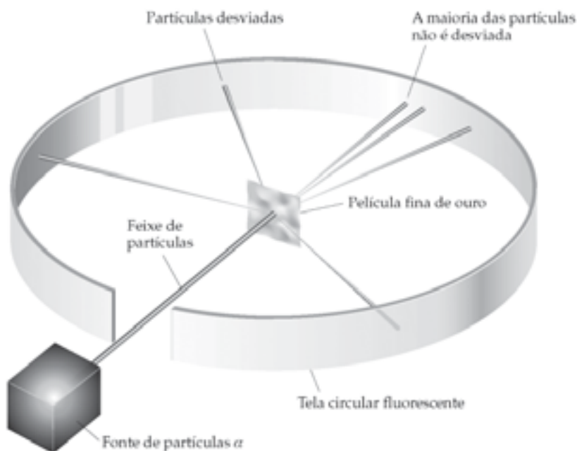
Figura 6: Aparelhagem montada por Rutherford sobre espalhamento das partículas \alpha . (Fonte: Brown, T. L.; et al. Química, a ciência central, 9 ed. São Paulo: Pearson Prentice Hall, 2005).
