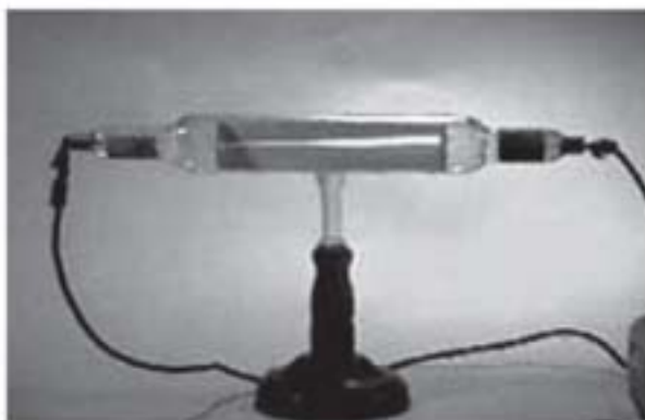
Raios catódicos: recipiente profundo com um eletrodo em cada extremidade. (Fonte: http://www.aip.org/history/electron/images/cathtube.jpg ).
