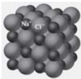
Figura 33 - A estrutura cristalina do cloreto de sódio. Cada um dos íons Na^+ é por seis íons Cl^- , e cada íon Cl^- é envolto por seis íons Na^+ .
