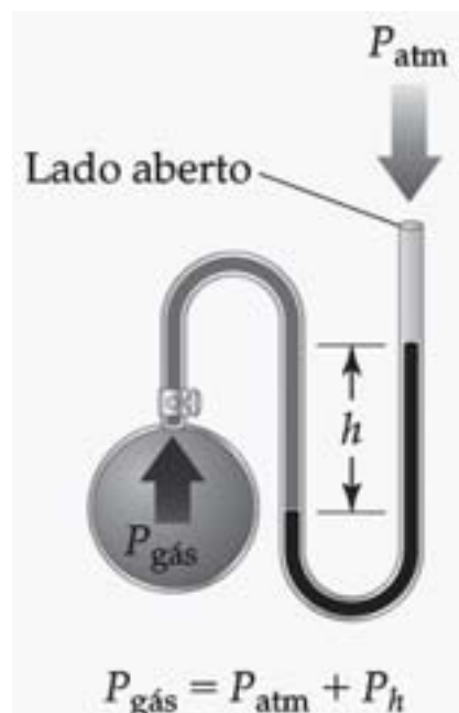
Figura 43: Um manômetro, algumas vezes empregado no laboratório para medir pressões de gases próximas à pressão atmosférica. (Livro – Química: A ciência central Bibliografia 4)
