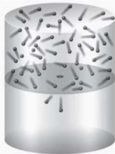
Figura 49 - Efusão de uma molécula de gás por um buraco de alfinete. As moléculas escapam de seu recipiente para um espaço evacuado apenas quando 'batem' no buraco. (Fonte: Brown, T. L.; et al. Química, a ciência central, 9 ed. São Paulo: Pearson Prentice Hall, 2005).
