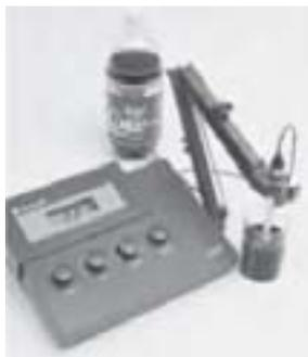
Figura 2. Medidor de pH digital
