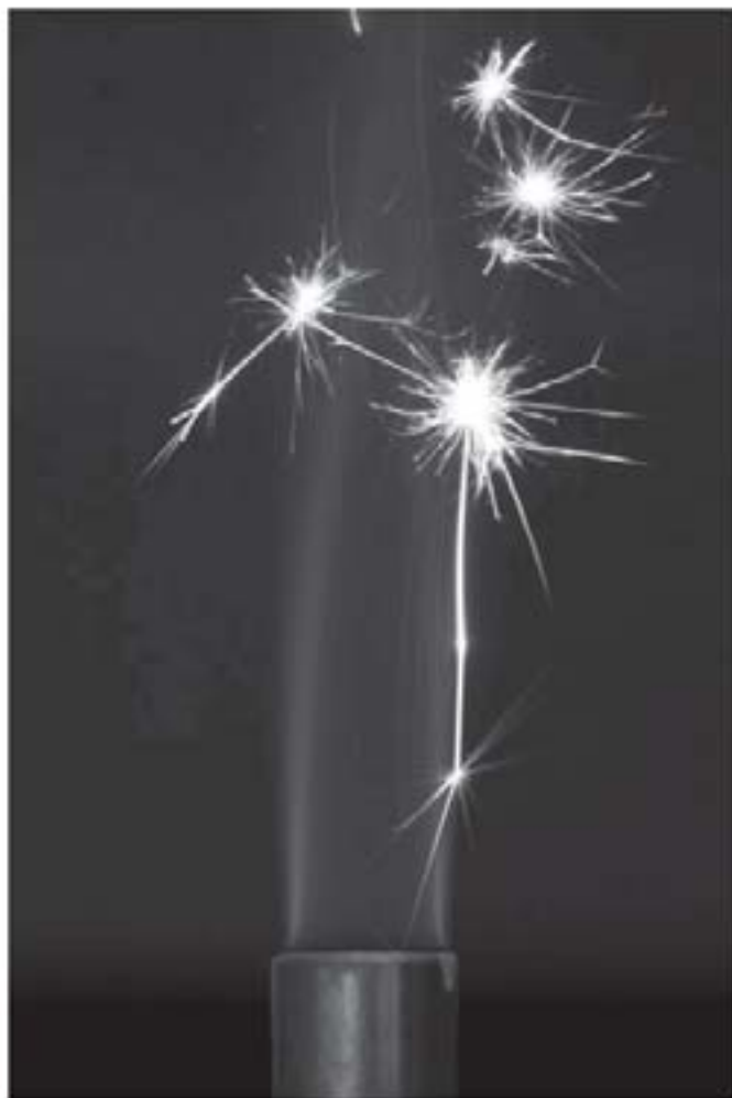
A centelha gerada por um dispositivo de aço golpeado contra um Ferrocerium provendo a energia de ativação para iniciar a combustão de um Bico de Bunsen. (Fonte: www.ptkipedia.org ).
