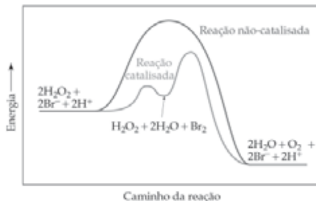
Figura 5: Perfil de energia para a decomposição do \text{H}_2\text{O}_2 não-catalisada e para a reação catalisada por \text{Br}^- .
