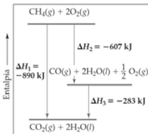
**Figura 5:** A quantidade de calor gerada pela combustão de 1 mol de  $\text{CH}_4$  depende se a reação ocorre em uma ou mais etapas.
