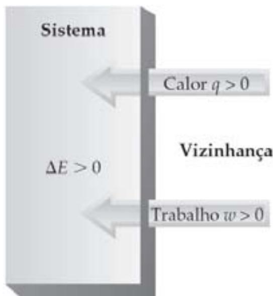
**Figura 1:** O calor,  $q$ , absorvido pelo sistema e o trabalho,  $w$ , realizado no sistema são grandezas positivas. Ambos servem para aumentar a energia,  $E$ , do sistema.
