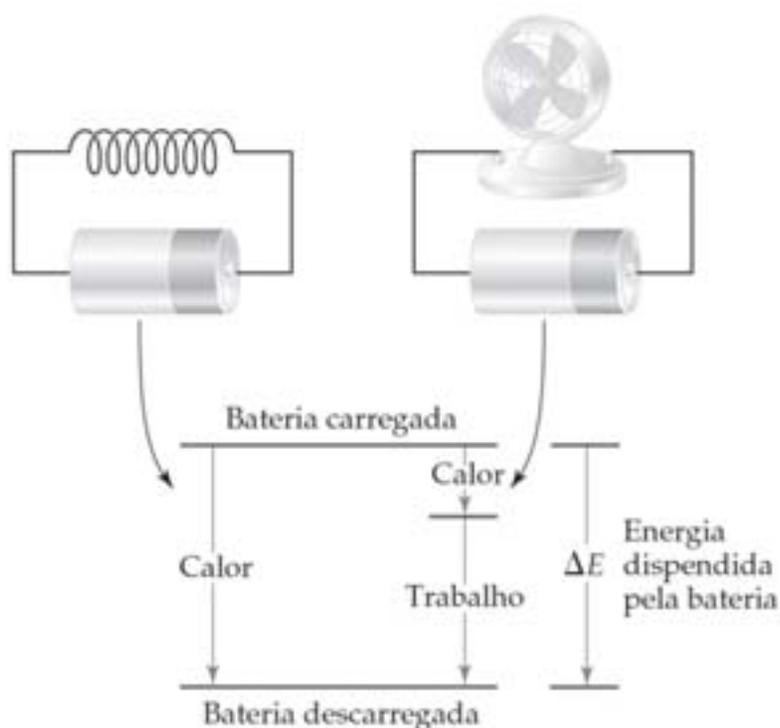
**Figura 2:** O sistema mostra: (a) Uma pilha conectada por um fio perde energia para a vizinhança na forma de calor; nenhum trabalho é realizado. (b) A pilha descarregada através de um motor dispende energia na forma de trabalho (para fazer o ventilador rodar) bem como na forma de calor. O valor de  $\Delta E$  é o mesmo para ambos os processos, mas o valor de  $q$  e de  $w$  são diferentes.
