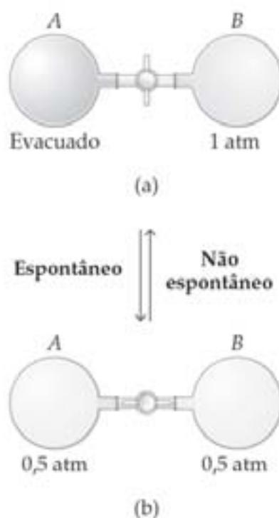
**Figura 3:** A expansão de um gás ideal em um espaço evacuado é espontânea. (a) O frasco B está cheio de um gás ideal a 1 atm de pressão e o frasco A está evacuado. (b) A torneira conectando os dois frascos foi aberta. O gás ideal expande-se até que a pressão dos dois frascos fique com a pressão de 0,5 atm. O processo inverso não é espontâneo.
