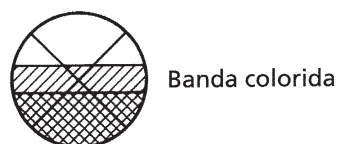
Refratômetro que mostra aberração cromática (dispersão da cor).
