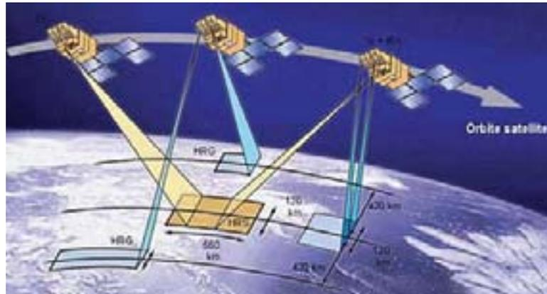
Figura 8.5 - Esquema do sensor HRS do sistema SPOT.
